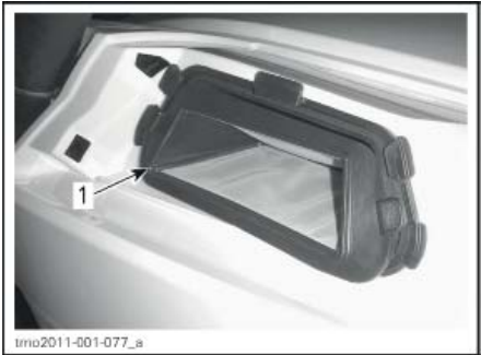
1. Воздушный фильтр вариатора
