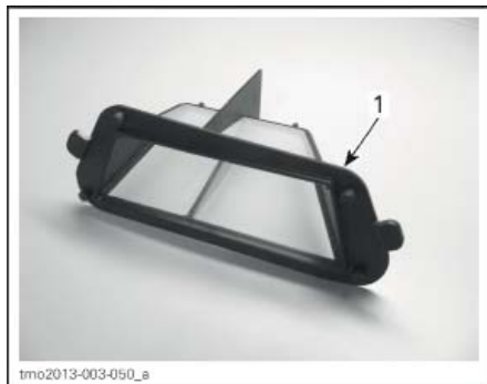
1. Воздушный фильтр вариатора
