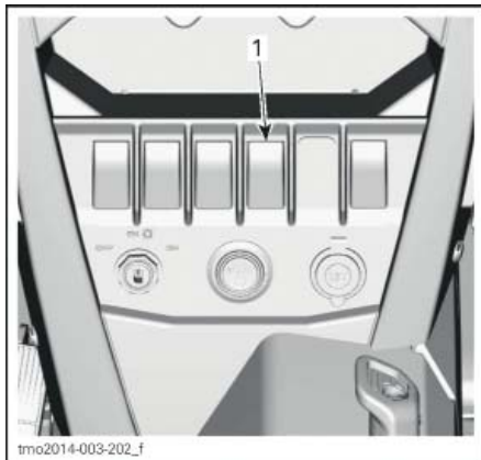
1. Переключатель усилителя руля DPS
