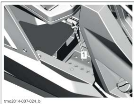
1. Дополнительный блок предохранителей
