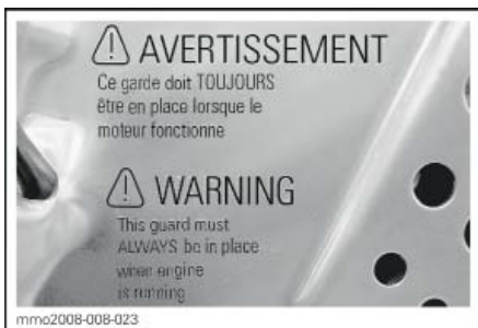
НАКЛЕЙКА 14 – НА ЗАЩИТЕ ДИСКОВОГО ТОРМОЗА (ГОЛЫЙ МЕТАЛЛ) – ДАННАЯ ЗАЩИТА ВСЕГДА ДОЛЖНА БЫТЬ УСТАНОВЛЕНА ВО ВРЕМЯ РАБОТЫ ДВИГАТЕЛЯ
