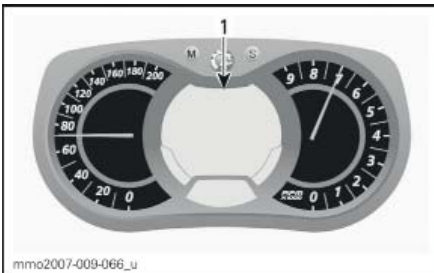
МНОГОФУНКЦИОНАЛЬНАЯ АНАЛОГОВО-ЦИФРОВАЯ ПАНЕЛЬ ПРИБОРОВ
