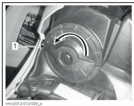
1. Крышка воздушного фильтра
