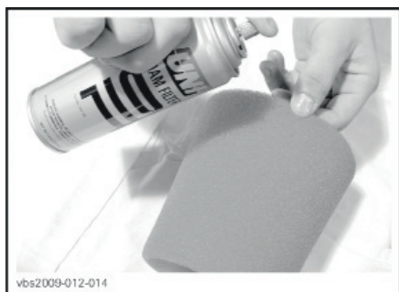
ТИПОВОЙ ВАРИАНТ - НАНЕСИТЕ МАСЛО НА ФИЛЬТРУЮЩИЙ ЭЛЕМЕНТ
