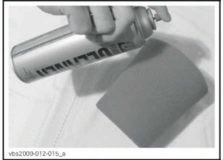
ТИПОВОЙ ВАРИАНТ – НАНЕСИТЕ ОЧИСТИТЕЛЬ НА ПОРОЛОНОВЫЙ ФИЛЬТР
