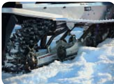
Энергоемкая подвеска PPS заточена под скоростные прохваты по жесткой гребенке
