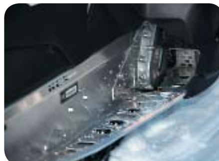
Мощные подножки с хорошо развитой перфорацией — для очистки от льда и снега
