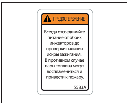
НА ТОПЛИВНЫХ ФОРСУНКАХ - МОДЕЛИ 600 E-TEC - НАКЛЕЙКА 11
