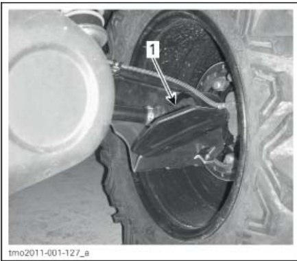
ЗАДНЯЯ ЧАСТЬ МОТОВЕЗДЕХОДА 1. Внешние (со стороны колес) пыльники приводных валов
