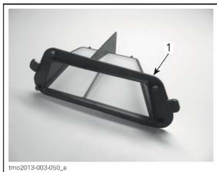
1. Воздушный фильтр вариатора
