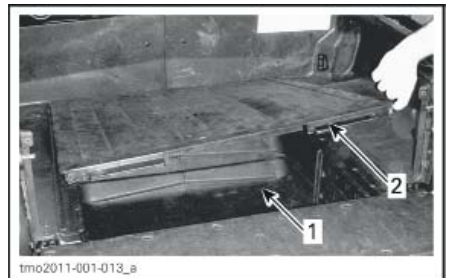
1. Увеличенный объем багажного отделения 2. Панель пола
