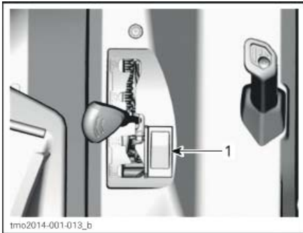
1. Кнопка блокировки автоматике
