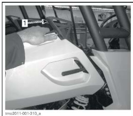
НАЖАТЬ ЧТОБЫ ЗАФИКСИРОВАТЬ 1. Защита рук
