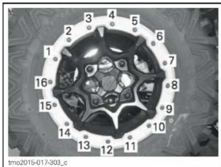
ТИПОВОЙ ВАРИАНТ – ПОСЛЕДОВАТЕЛЬНОСТЬ ЗАТЯЖКИ (ПОСЛЕДНИЙ ПРОХОД)
