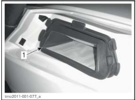
1. Воздушный фильтр вариатора
