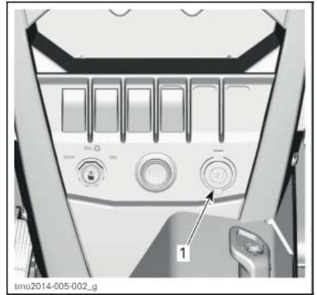
1. Электрическая розетка (12 В)
