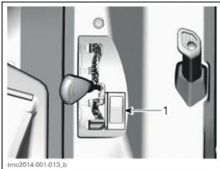
1. Кнопка блокировки автоматки
