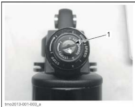
тимо2013-001-003_a ТИПОВОЙ ВАРИАНТ – МОДЕЛЬ XT-P 1. Регулятор медленного сжатия
