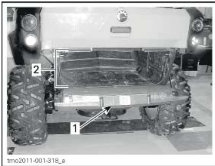
1. Нижний откидной борт 2. Нижняя секция
