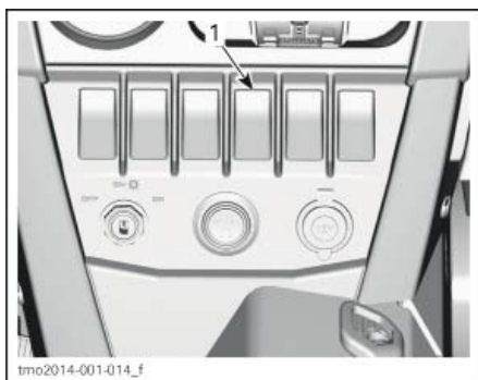
1. Переключатель усилителя руля DPS
