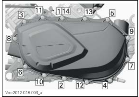
ПОСЛЕДОВАТЕЛЬНОСТЬ ЗАТЯЖКИ КРЫШКИ ВАРИАТОРА
