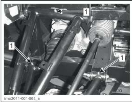
ПЕРЕДНЯЯ ПОДВЕСКА - ТИПОВОЙ ВАРИАНТ 1. Пресс-масленки
