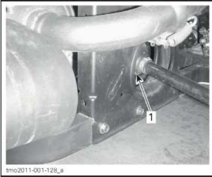
ЗАДНЯЯ ЧАСТЬ МОТОВЕЗДЕХОДА 1. Внутренние (со стороны дифференциала) пыльники приводных валов
