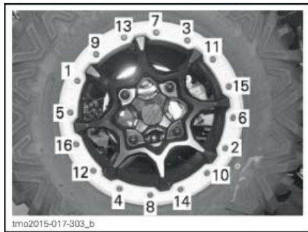
ТИПОВОЙ ВАРИАНТ – ПОСЛЕДОВАТЕЛЬНОСТЬ ЗАТЯЖКИ
