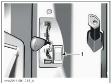
1. Кнопка блокировки автоматике
