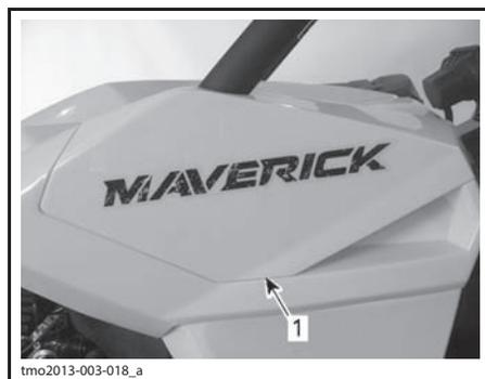
1. Пластмассовая крышка воздушного фильтра вариатора
