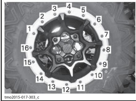
ТИПОВОЙ ВАРИАНТ - ПОСЛЕДОВАТЕЛЬНОСТЬ ИТОГОВОЙ ЗАТЯЖКИ
