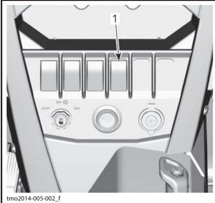
1. Переключатель режимов работы усилителя рулевого управления (DPS)
