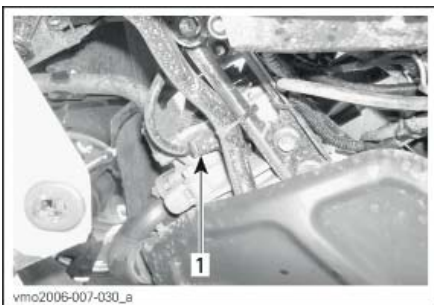
ЛЕВАЯ СТОРОНА – ПЕРЕДНИЙ ЦИЛИНДР 1. Свеча зажигания
