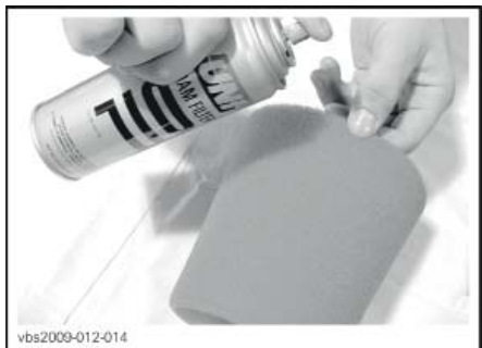
ТИПОВОЙ ВАРИАНТ – НАНЕСИТЕ МАСЛО НА ФИЛЬТРУЮЩИЙ ЭЛЕМЕНТ
