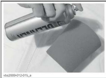
ТИПОВОЙ ВАРИАНТ – НАНЕСИТЕ ОЧИСТИТЕЛЬ НА ПОРОЛОНОВЫЙ ФИЛЬТР
