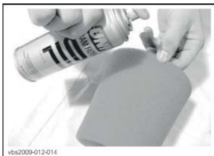
ТИПОВОЙ ВАРИАНТ - НАНЕСИТЕ МАСЛО НА ФИЛЬТРУЮЩИЙ ЭЛЕМЕНТ
