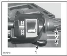
1. Рычаг управления дроссельной заслонкой А 2 мм
