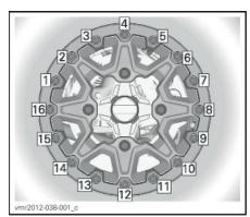
ПОСЛЕДОВАТЕЛЬНОСТЬ ЗАКЛЮЧИТЕЛЬНОЙ ЗАТЯЖКИ
