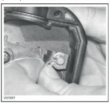
Снимите боковую крышку корпуса дроссельной заслонки.
