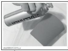
ТИПОВОЙ ВАРИАНТ – НАНЕСИТЕ ОЧИСТИТЕЛЬ НА ВНУТРЕННЮЮ И ВНЕШНЮЮ СТОРОНЫ ФИЛЬТРУЮЩЕГО ЭЛЕМЕНТА
