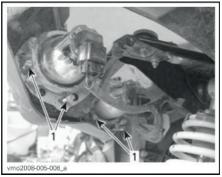
ТИПОВОЙ ВАРИАНТ 1. Регулировочные винты
