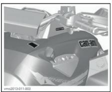
РАСПОЛОЖЕНИЕ РЫЧАГА ПЕРЕКЛЮЧЕНИЯ ПЕРЕДАЧ
