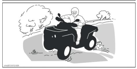
В случае, если вы попали в скольжение или занос, поворот руля в сторону заноса может помочь вам вернуть управление мотовездеходом. Ни в коем случае не блокируйте тормоза и колеса.
