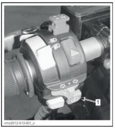
ТИПОВОЙ ВАРИАНТ 1. Кнопка запуска двигателя
