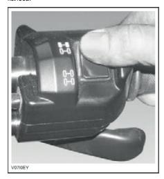
ТИПОВОЙ ВАРИАНТ – РЕЖИМ 2WD
