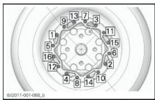
ТИПОВОЙ ВАРИАНТ - ПОСЛЕДОВАТЕЛЬНОСТЬ ЗАТЯЖКИ
