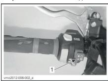
1. Аварийный выключатель двигателя
