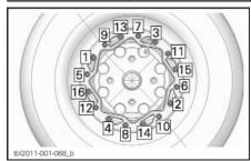
ТИПОВОЙ ВАРИАНТ - ПОСЛЕДОВАТЕЛЬНОСТЬ ЗАТЯЖКИ
