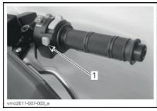
1. Кнопка блокировки автоматики / Переключения режимов работы усилителя руля
