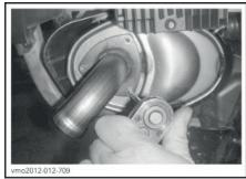
ТИПОВОЙ ВАРИАНТ - СНИМИТЕ ВЫХЛОПНУЮ TPVFV
