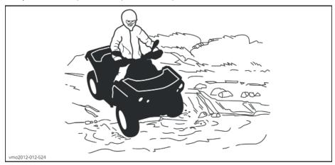
Мокрые тормоза негативно повлияют на возможности тормозной системы. После движения по воде, грязи или снегу обязательно несколько раз приводите в действия тормоза, для того чтобы просушить их. Оставляйте больше места для торможения.
