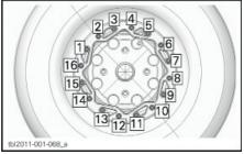
ТИПОВОЙ ВАРИАНТ - ПОСЛЕДОВАТЕЛЬНОСТЬ ПОСЛЕДНЕГО ПРОХОДА
