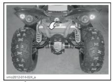
ТИПОВОЙ ВАРИАНТ – РАСПОЛОЖЕНИЕ ЗАДНЕЙ ТОЧКИ КРЕПЛЕНИЯ
