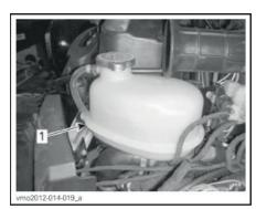
1. Расширительный бачок системы охлаждения
