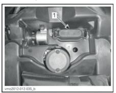
1. Крышка заднего блока предохранителей
