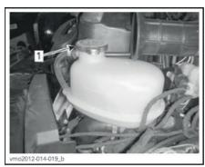
Крышка расширительного бачка системы охлаждения
