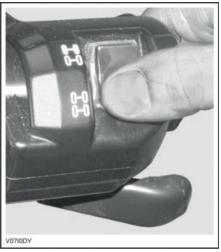
ТИПОВОЙ ВАРИАНТ – РЕЖИМ 4WD
