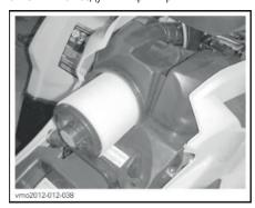
СНЯТИЕ ВОЗДУШНОГО ФИЛЬТРА
