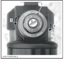
РЕГУЛИРОВКА ДЕМПФИРОВАНИЯ БЫСТРОГО СЖАТИЯ (ВОСПОЛЬЗУЙТЕСЬ КЛЮЧОМ 17 ММ)
