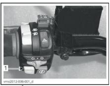
ТИПОВОЙ ВАРИАНТ 1. Кнопка звукового сигнала
