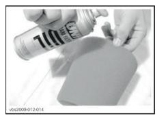
ТИПОВОЙ ВАРИАНТ – НАНЕСИТЕ МАСЛО НА ФИЛЬТРУЮЩИЙ ЭЛЕМЕНТ
